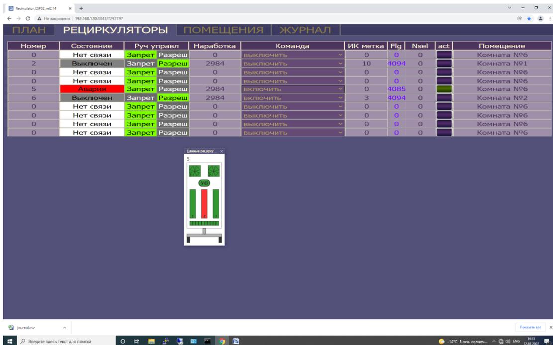
Рисунок 31 – Вид окна «Рециркуляторы» с БОРТ-ИТ, имеющего неисправность ультрафиолетовой лампы с отображением на индивидуальном окне.
